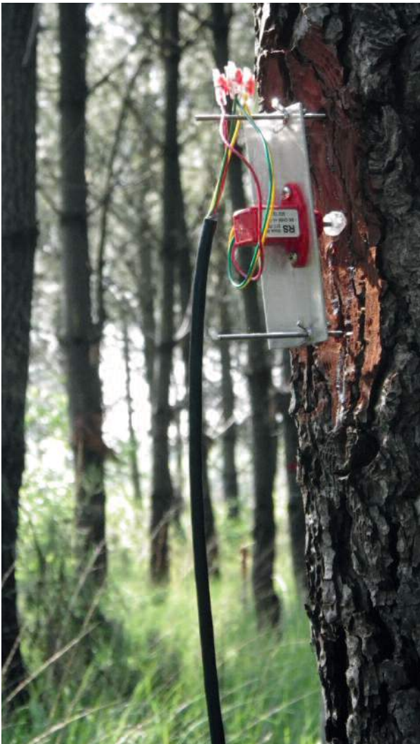
Etude la croissance en relation avec la disponibilité en eau : capteur de croissance radiale, dans une parcelle suivie simultanément pour différents paramètres environnementaux (photo R. Segura, INRA).
